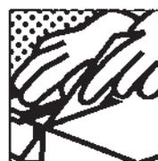
Couper au couteau sur une surface rigide. Ne pas utiliser de scie, surtout mécanique.
